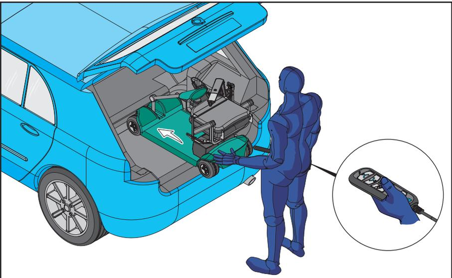
10. Guidare manualmente il dispositivo di mobilità nel bagagliaio come mostrato, tenendo premuto il PULSANTE DENTRO sul telecomando. Rilasciare il PULSANTE DENTRO quando il dispositivo di mobilità è nella posizione corretta.
