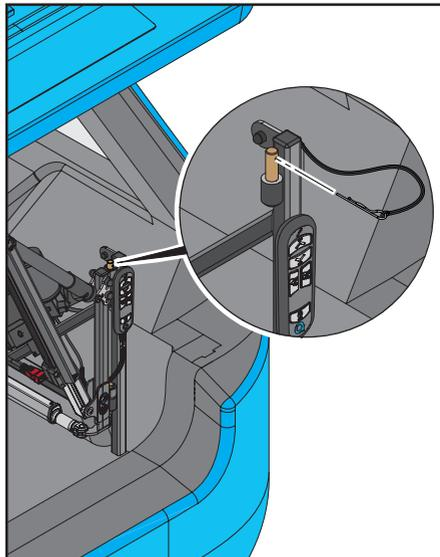
6. Rimuovere la molletta a R nel perno superiore sul telaio ad A / telaio universale ad A.
