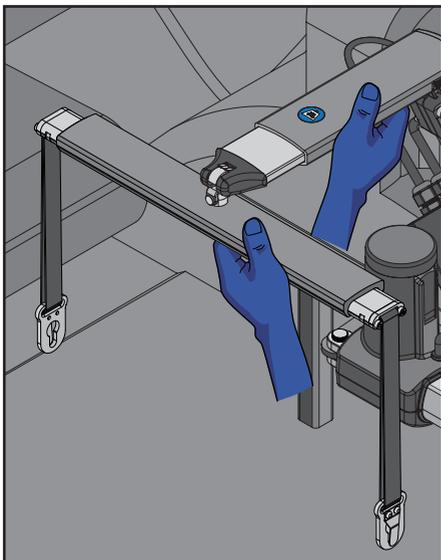
1. Rimuovere il supporto di sollevamento dallo Smart Lifter. Posizionare una mano sullo Smart Lifter e con l'altra sostenere il supporto di sollevamento.
