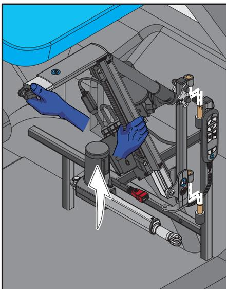
7. Rimuovere lo Smart Lifter dal Telaio ad A / Telaio universale ad A come illustrato.
