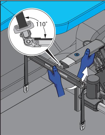
7. Fissare il supporto di sollevamento alla gruetta. Inclinare il supporto di sollevamento a  $110^{\circ}$  per agganciare il gancio allo Smart Lifter come mostrato.
