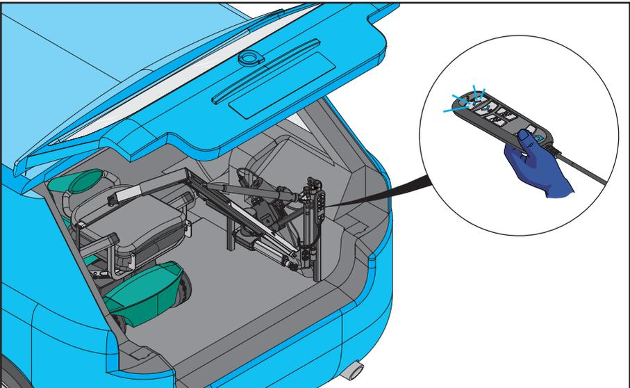
12. Smart Lifter in posizione riposta. Utilizzando il telecomando, premere il PULSANTE ON/OFF sul telecomando per spegnere la gruetta. Riposizionare il telecomando.
