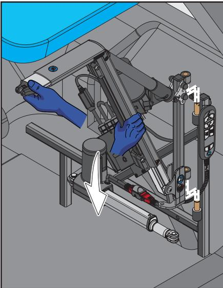
3. Posizionare lo Smart Lifter sopra i perni sul Telaio ad A. Appoggiare il capocorda di montaggio inferiore sul perno inferiore più lungo prima di allineare il perno superiore. Assicurarsi che lo Smart Lifter sia fissato correttamente.
