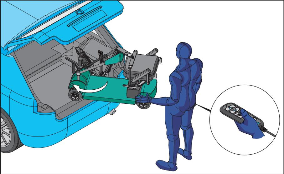
9. Ruotare il dispositivo di mobilità in modo che sia rivolto verso il veicolo. Tenere premuto il PULSANTE DENTRO.
