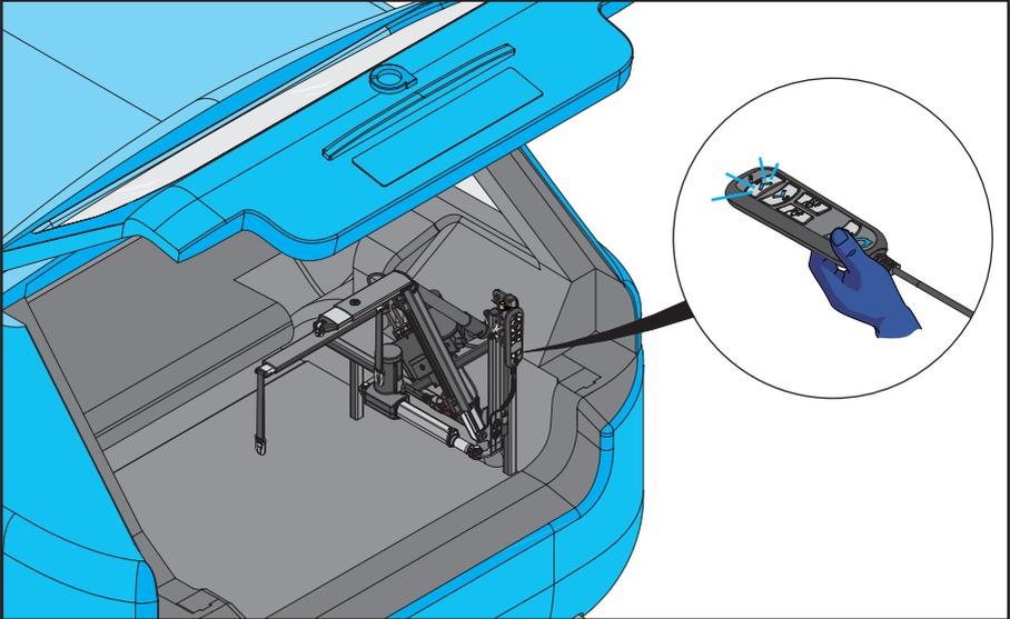
1. Smart Lifter in posizione nel bagagliaio del veicolo. Utilizzando il telecomando, premere il PULSANTE ON/OFF sul telecomando come mostrato. In questo modo si accende il telecomando e si avvia la gruetta.
