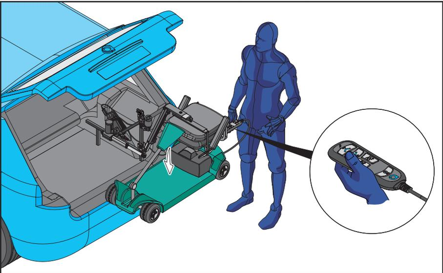
6. Lo Smart Lifter è mostrato in posizione completamente estratta. Tenere premuto il PULSANTE GIÙ per abbassare il dispositivo di mobilità. Rilasciare il PULSANTE GIÙ quando il dispositivo di mobilità è saldamente appoggiato a terra.
