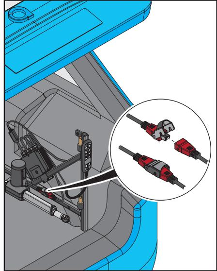
2. Collegare il connettore rosso dell'attuatore elettrico al connettore rosso sulla Centralina di controllo.
