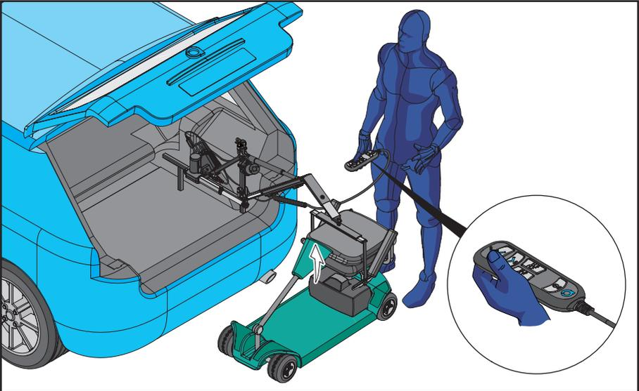
9. Quando lo Smart Lifter viene staccato dal dispositivo di mobilità, Tenere premuto il PULSANTE SU del telecomando. Rilasciare il PULSANTE SU una volta che lo Smart Lifter sia nel punto più alto.
