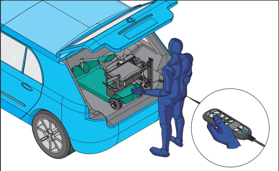
11. Quando il dispositivo di mobilità è in posizione nel bagagliaio. Tenere premuto il PULSANTE GIÙ e guidare il dispositivo di mobilità in posizione. Rilasciare il PULSANTE GIÙ quando il dispositivo di mobilità è appoggiato sul pavimento del bagagliaio.
