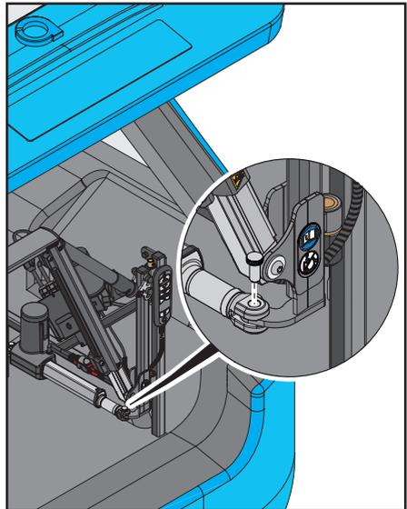
4. Inserire il secondo perno zigrinato nello Smart Lifter e nell'attuatore elettrico.
