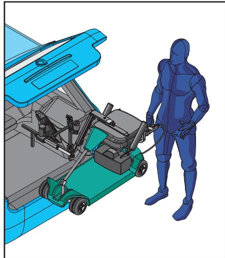
8. Rilasciare il PULSANTE SU una volta che lo Smart Lifter sia nel punto più alto. Verificare che il dispositivo di mobilità sia livellato.
