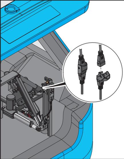
5. Collegare il connettore dell'attuatore elettrico grigio SU/GIÙ al connettore grigio sulla Centralina di controllo.
