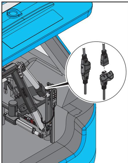
5. Conecte el conector gris DE SUBIDA/BAJADA del actuador al conector gris de la caja de control.
