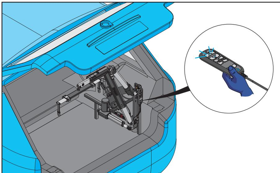
12. El Smart Lifter se muestra en posición de guardado. Utilizando el mando, pulse el BOTÓN DE ENCENDIDO/APAGADO en el control remoto para apagar la grúa. Reemplace el mando.
