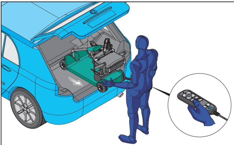
4. Introduzca manualmente el dispositivo de movilidad en el maletero como se muestra mientras mantiene pulsado el BOTÓN DE SALIDA en el mando.
