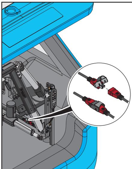
1. Desconecte el conector rojo del actuador del conector rojo de la caja de control.
