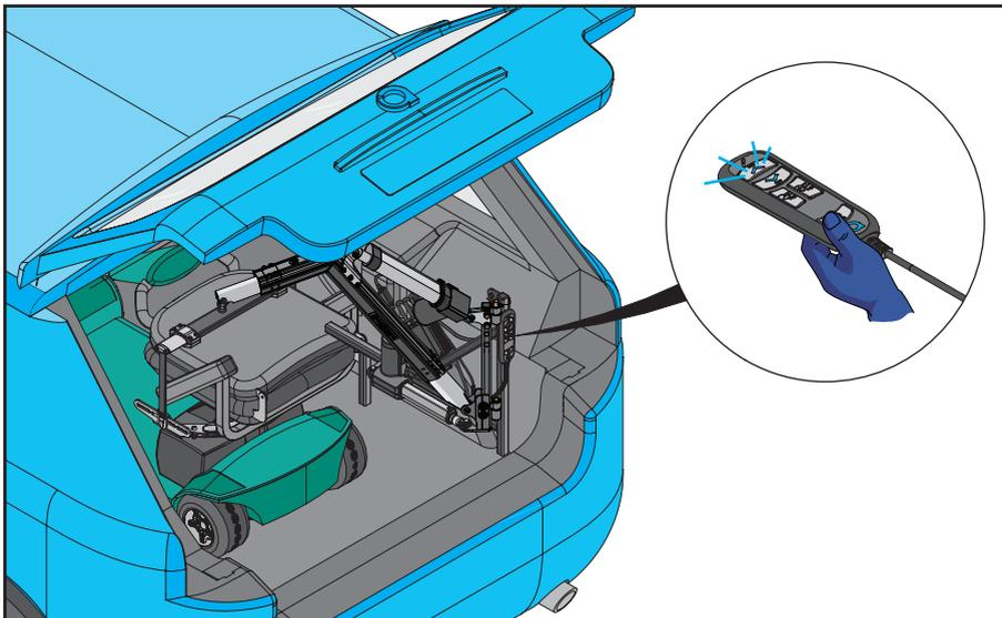
1. El Smart Lifter se muestra en posición de guardado. Utilizando el mando, pulse el **BOTÓN DE ENCENDIDO/APAGADO** del control remoto tal como se muestra. Esto iluminará el control remoto y encenderá la grúa.
