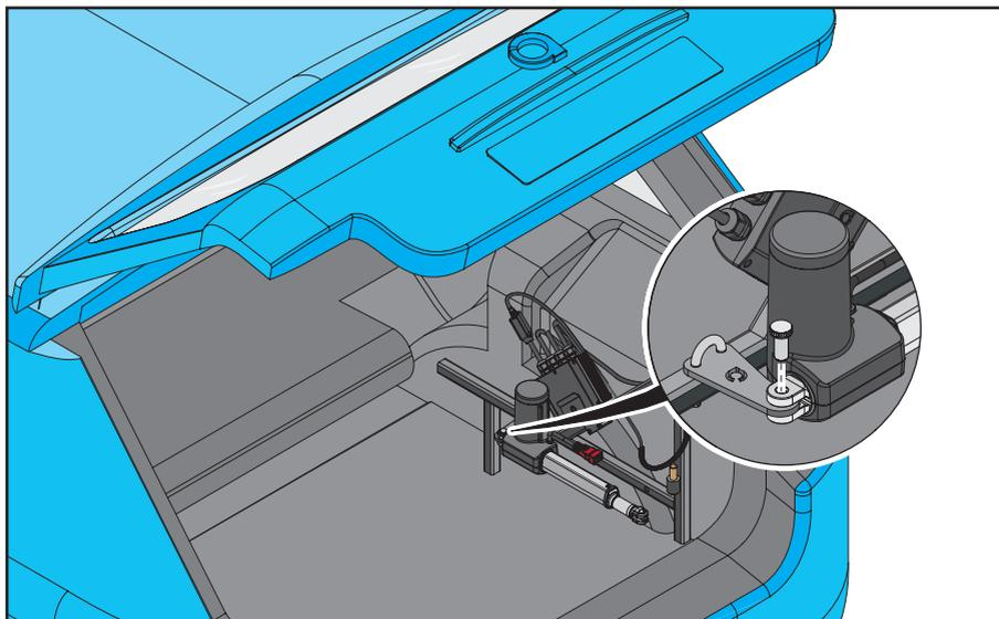
6. Retire el segundo pasador estriado del actuador y la abrazadera tal como se muestra. Retire el actuador deslizando el extremo fuera de la abrazadera.
