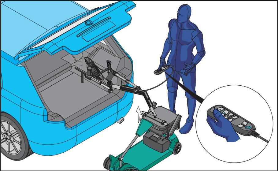
9. Cuando el Smart Lifter se separe del dispositivo de movilidad, pulse y mantenga pulsado el BOTÓN DE SUBIDA del mando. Suelte el BOTÓN DE SUBIDA una vez que el Smart Lifter esté en el punto más alto.
