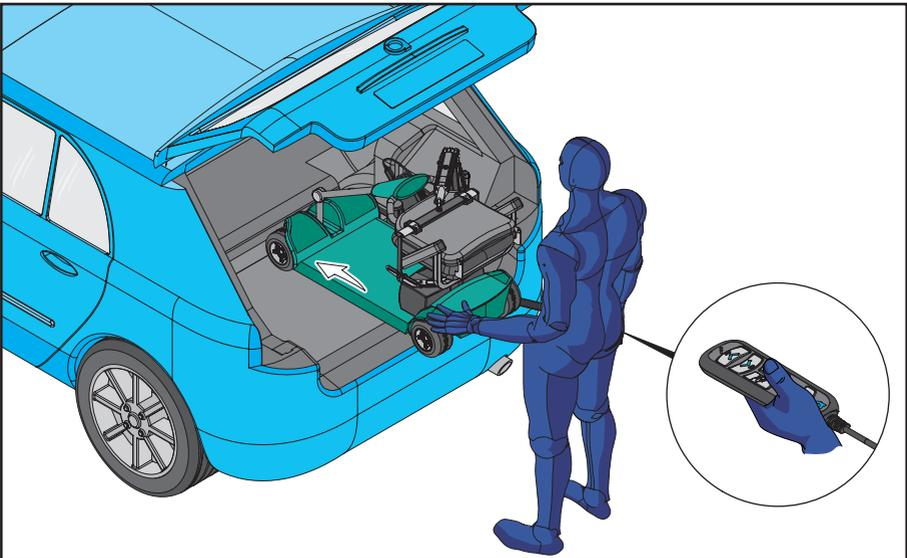
10. Introduzca manualmente el dispositivo de movilidad en el maletero como se muestra mientras mantiene pulsado el BOTÓN DE ENTRADA en el mando. Suelte el BOTÓN DE ENTRADA cuando el dispositivo de movilidad esté en la posición correcta.
