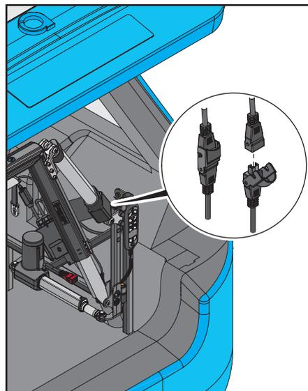
2. Desconecte el conector gris DE SUBIDA/BAJADA del actuador del conector gris de la caja de control.
