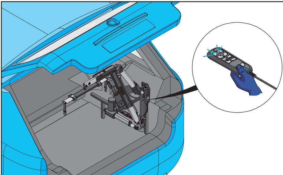
1. Coloque el Smart Lifter en el maletero del vehículo. Utilizando el mando, pulse el **BOTÓN DE ENCENDIDO/APAGADO** del control remoto tal como se muestra. Esto iluminará el control remoto y encenderá la grúa.
