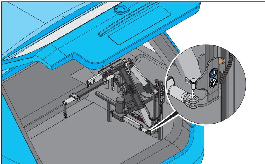
4. Introduzca el segundo pasador estriado en el Smart Lifter y el actuador tal como se muestra.
