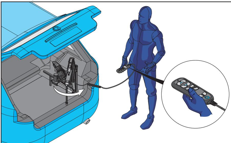
2. Pulse y mantenga pulsado el **BOTÓN DE SALIDA** tal como se muestra. Suelte el **BOTÓN DE SALIDA** una vez que el Smart Lifter esté en posición de salida total.
