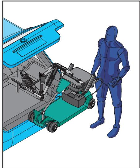
8. Suelte el BOTÓN DE SUBIDA una vez que el Smart Lifter esté en el punto más alto. Asegúrese de que el dispositivo esté nivelado.
