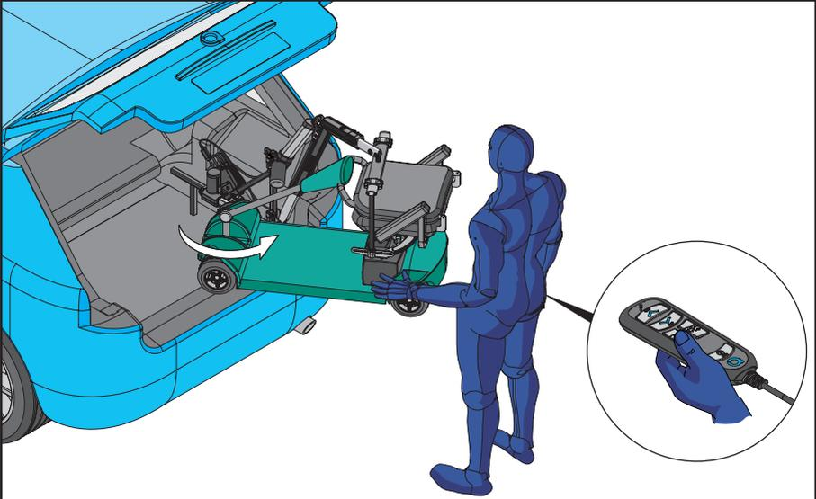
5. Gire el dispositivo de movilidad para sacarlo del vehículo mientras mantiene pulsado el BOTÓN DE SALIDA. Suelte el BOTÓN DE SALIDA una vez que el Smart Lifter esté en posición de salida total.
