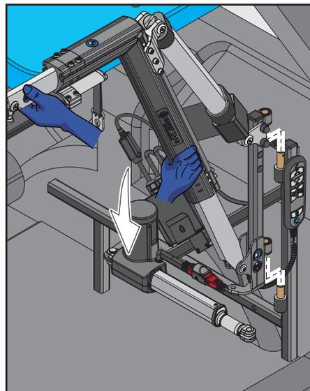
3. Coloque el Smart Lifter sobre los pasadores del Soporte A. Apoye la orejeta de montaje inferior sobre el pasador inferior más largo antes de alinear el pasador superior. Asegúrese de que el Smart Lifter está encajado firmemente.
