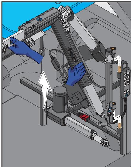
5. Retire el Smart Lifter del Soporte A/ Soporte A universal tal como se muestra.
