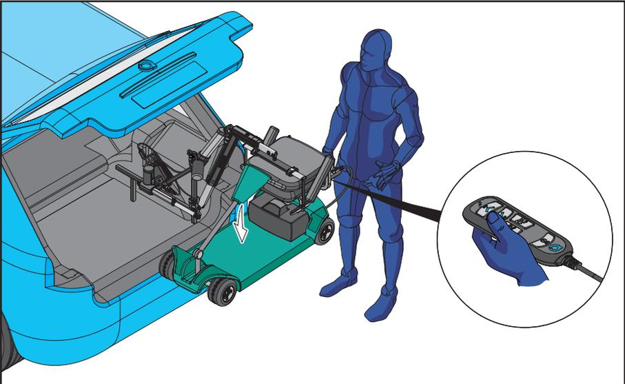
6. El Smart Lifter se muestra en posición de salida total. Pulse y mantenga pulsado el BOTÓN DE BAJADA para bajar el dispositivo de movilidad. Suelte el BOTÓN DE BAJADA cuando el dispositivo de movilidad esté firmemente apoyado en el suelo.
