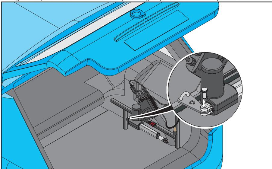
1. Fije el actuador deslizándolo sobre la abrazadera. Deslice el pasador estriado en el actuador y la abrazadera tal como se muestra.
