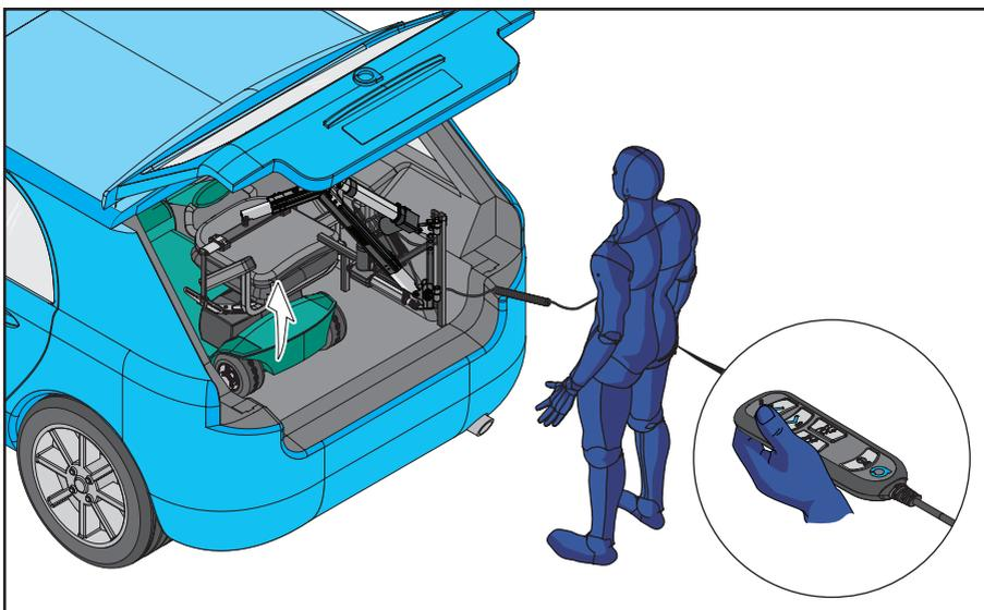
2. Para elevar el dispositivo de movilidad, Pulse y mantenga pulsado el **BOTÓN DE SUBIDA** del mando. Suelte el **BOTÓN DE SUBIDA** una vez que el Smart Lifter esté en el punto más alto. Asegúrese de que el dispositivo esté nivelado.
