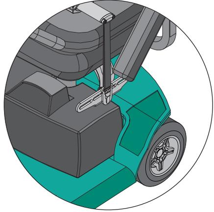
6. Asegúrese de que los puntos de elevación estén sujetos firmemente. **NO** intente hacer una elevación sin que todas las correas de elevación estén firmemente conectadas.
