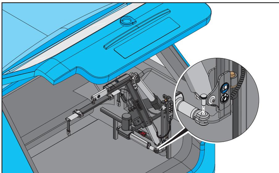
3. Retire el pasador estriado del Smart Lifter y del actuador tal como se muestra.
