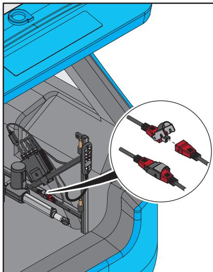
2. Conecte el conector rojo del actuador al conector rojo de la caja de control.
