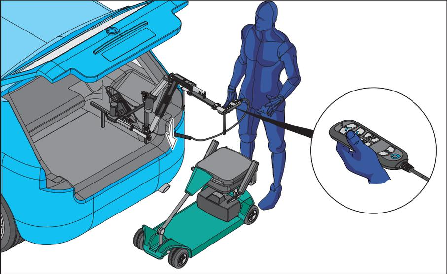
3. El Smart Lifter se muestra en posición de salida total. Pulse y mantenga pulsado el BOTÓN DE BAJADA para mover el arnés de grúa hacia el dispositivo de movilidad. Suelte el BOTÓN DE BAJADA cuando el arnés de grúa esté a la altura deseada.
