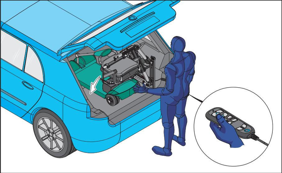
11. Cuando el dispositivo de movilidad esté en posición en el maletero, pulse y mantenga pulsado el BOTÓN DE BAJADA y guíe el dispositivo de movilidad hasta su posición. Suelte la TECLA DE BAJADA cuando el dispositivo de movilidad esté apoyado sobre el suelo del maletero.
