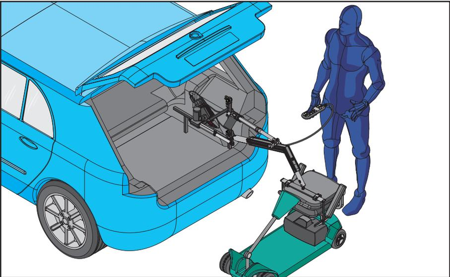
4. El Smart Lifter se muestra en posición sobre el dispositivo de movilidad.
